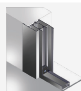
E: Installation i öppning med en invändig täcklist
